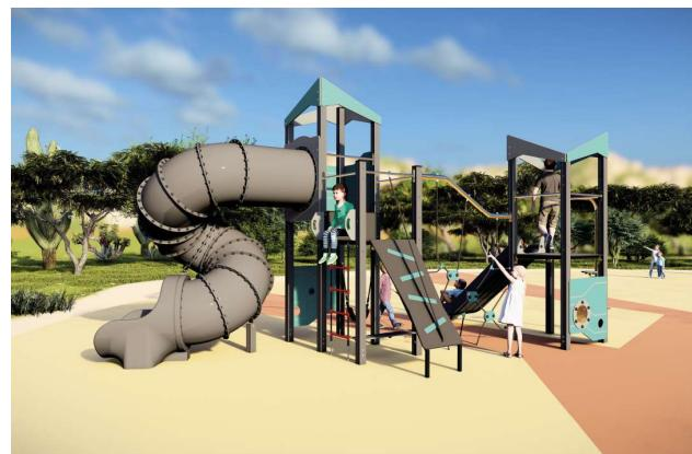
El descenso de la torres puede realizarse mediante los mismos accesos, un tobogán abierto de 1,30m o por un tobogán en espiral de 1,90 m de altura. Las torres están conectadas por una red de trepa con cuerdas distribuidas en diagonal y paneles de polietileno.
